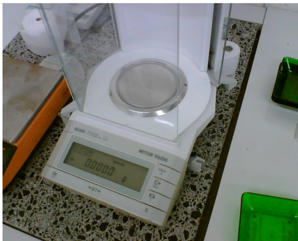
Wiegen der Bleche mit einer Feinwaage
